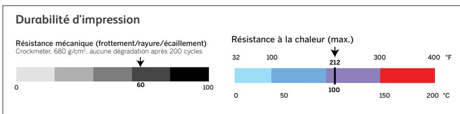
Évaluation par Videojet des performances observées du ruban Texture rugueuse avec optimisation de la configuration et des récepteurs de l'imprimante.
